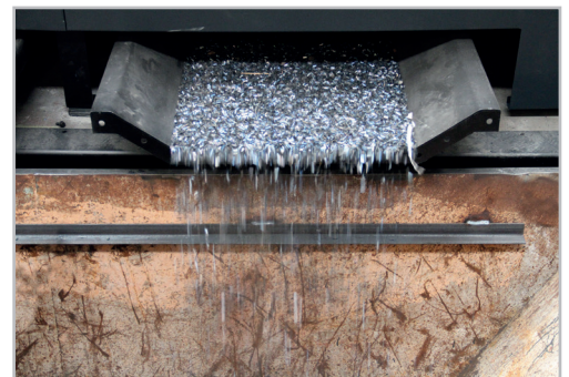
Dross collection with VIBRATEC® System Recogida de escoria con sistema VIBRATEC®
