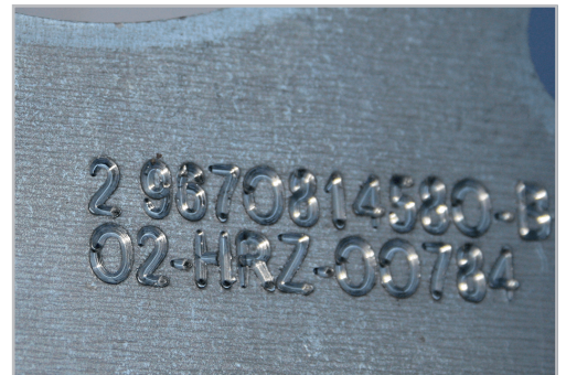
Piece marking Detalle marcado de piezas
