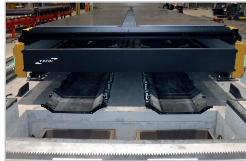
Chip automatic extraction Extracción automática de viruta
