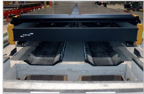
Chip automatic extraction Extracción automática de viruta
